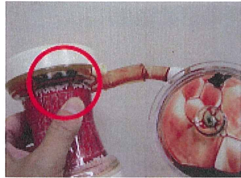
図8 人工肺の血栓形成例
