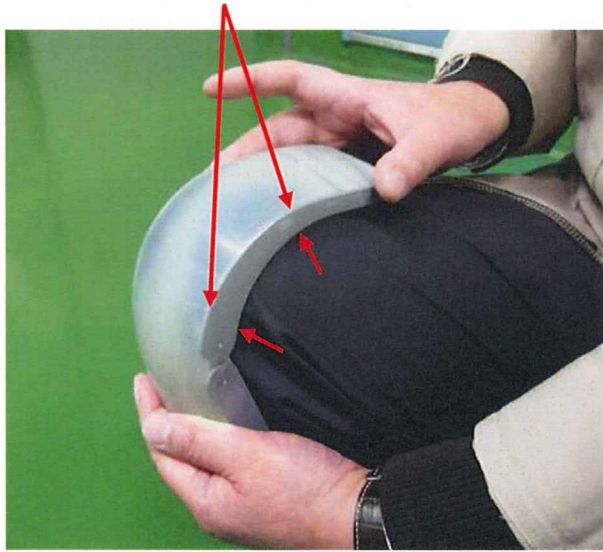
図Ⅲ-10 フレームを膝の曲面に沿う形状に変更
