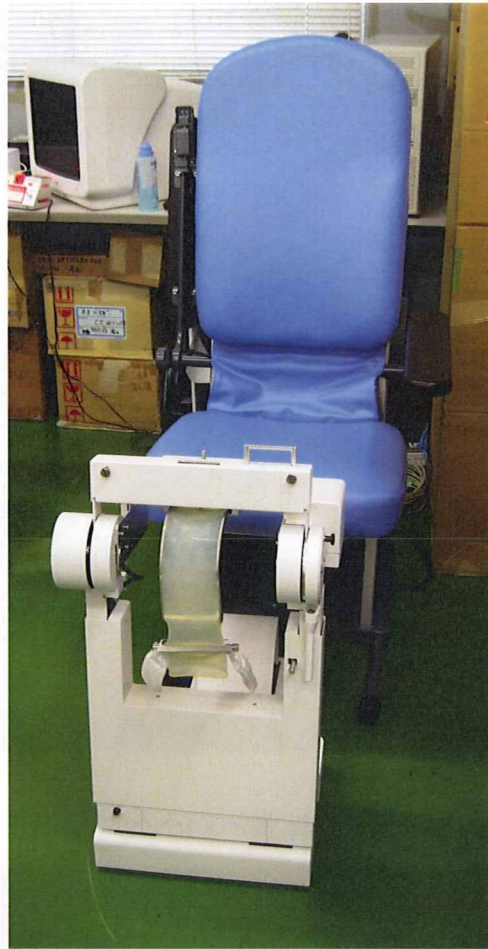
図Ⅲ-1 新規に再製作した超音波プローブスキャナーの概観
