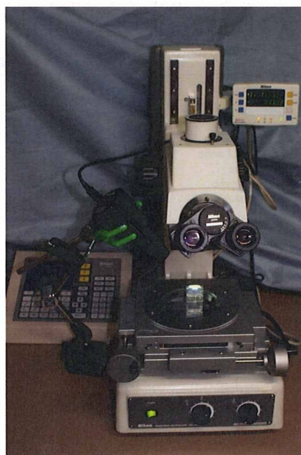
図 ①-9 測定顕微鏡による軟骨厚測定 生理食塩水滴下後カバーガラスにより被覆し、骨軟骨片の湿潤を保持
