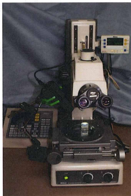
図 1-8 軟骨厚測定に使用した測定顕微鏡
