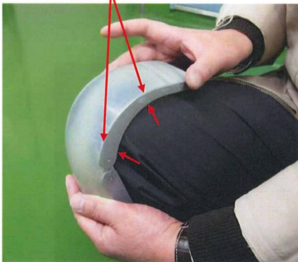
図12 フレームを膝の曲面に沿う形状に変更
