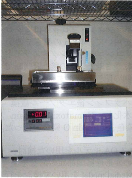
図 3. Ball-on-Flat 摩擦試験機
