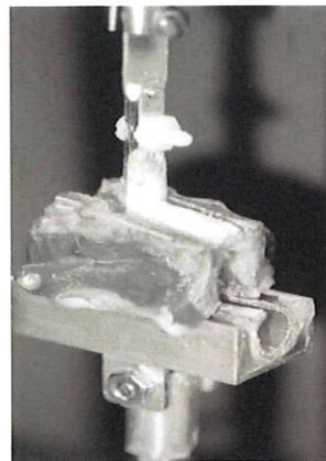
図 6. レオメーターでの硬膜—椎体破断張力の測定
