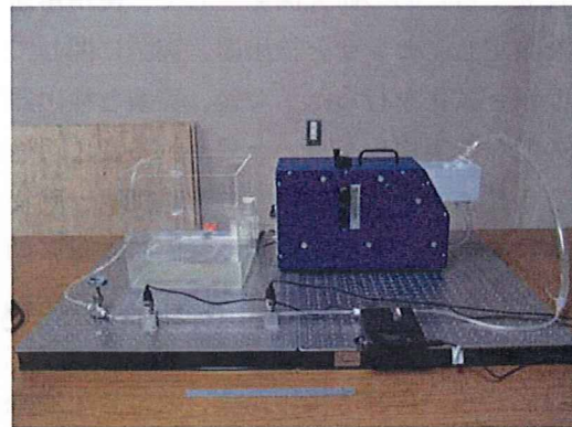
図4 実装デバイス評価用拍動循環モデル
