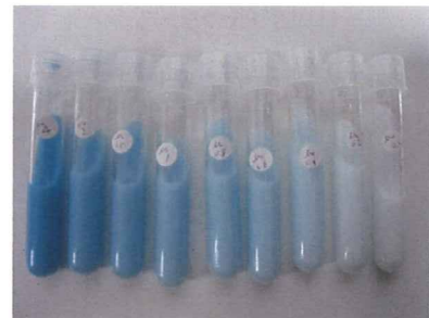
図11 吸収体の濃度を変化させた評価用サンプル
