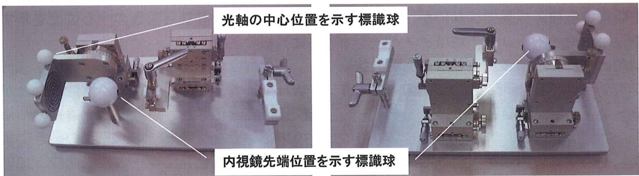
図6 立体内視鏡光軸キャリブレーター
