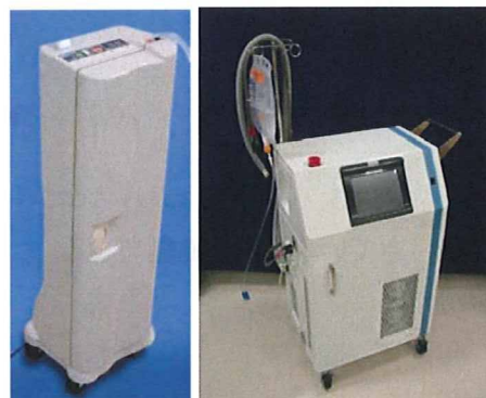
図 1 4 . 初期型冷却水灌流装置(左)と、改良型冷却水灌流装置(右)改良型は灌流液温度、灌流圧データを冷却カフより取得し自動制御を行う。
