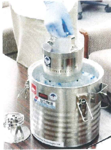
京大が開発した治療用細胞を運搬するための専用容器＝18日午後、京都市左京区
