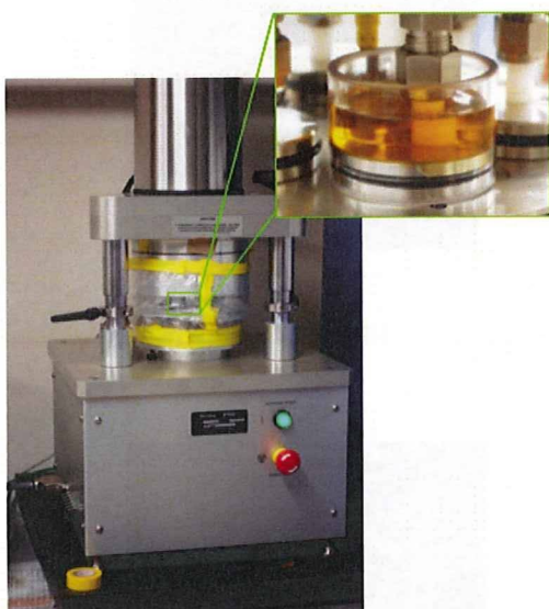
図 2. pin-on-disc 型摩耗試験装置 (AMTI 製 Ortho-POD)
