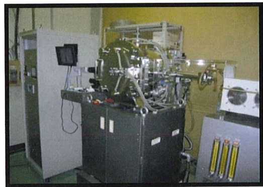
図 1. フッ化物結晶育成に用いたチャンバー型 \mu -PD装置の概観。
