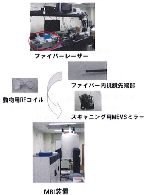
図8：共同で開発したMR対応ファイバーレーザーの構成と概観、およびSC、いままでの複雑な光学系をほとんどをファイバ化し、移動や保守を簡素化することで、臨床応用につなげる。出力部もファイバ化されているため、内視鏡装置への接続や、MRI装置へ組み込みが容易である。さらに図7に示したSC光化により650~1400nmまでのフェムト秒パルスを一度に利用可能になり、生体深部のがん細胞の可視化も可能になると期待できる。
