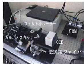
図: マルチモーダルデバイスの光学部分のプロトタイプシステム: 右下の伝送用ファイバーが、ショット社の協力を得て作成したバンドルファイバー
