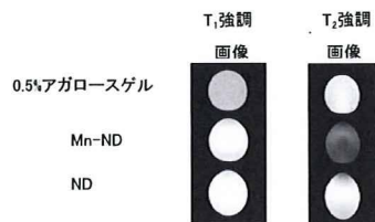
図3. 0.5%アガロースゲル、2mg/mlのマンガンイオン注入したNDを含んだ0.5%アガロースゲル、および2mg/mlのNDを含んだ0.5%アガロースゲルでのT 1 強調画像、およびT 2 強調画像の比較
