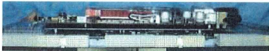
図6 新CPU基板の写真 上：GPU基板が搭載されている可能 下：CPU基板を横から見た写真
