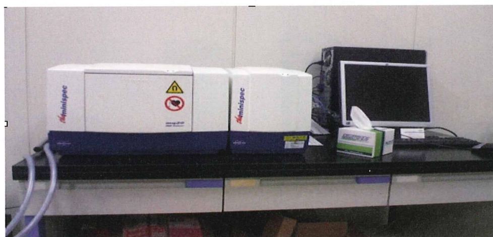
Fig. 6-1-20 パルス磁場勾配型核磁気共鳴装置 ミニスペック
