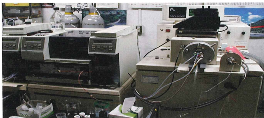
Fig. 6-1-05 エレクトロスプレーイオン化トリプルステージ四重極質量分析計 (ESI-TSQ) フィニガン・マット社 SSQ 7000
