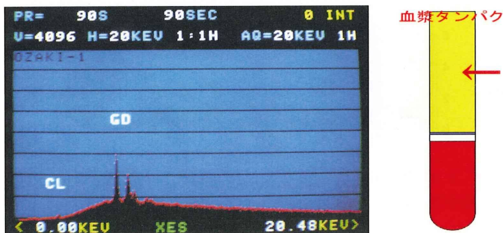
Fig. 6-1-11 血漿タンパクと Gd-DTPA-AS1-2Glc(OH) の混和による特性 X 線の測定
