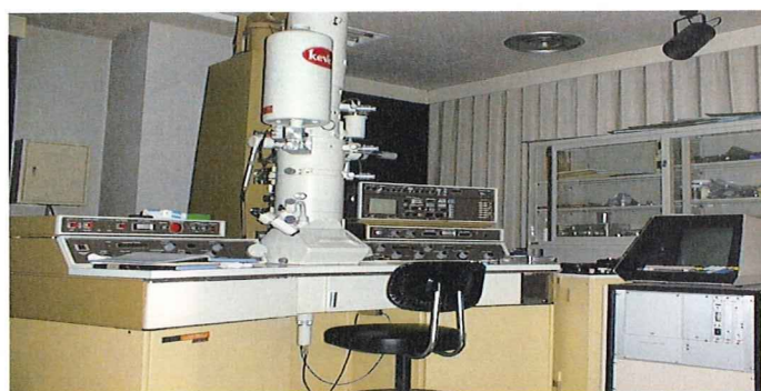
Fig. 6-1-08 複合電子顕微鏡システム 日本電子 JEM200CX
