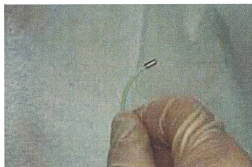
図 8 外径 2.6 mm × 内径 1.8 mm × 長さ 5 mm の磁石を装着した外径 5 Fr カテーテルの、3.5 kOe での屈曲
