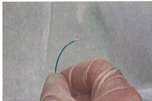
図 7 外径 0.7 mm × 長さ 5 mm の磁石を装着した外径 0.035 インチガイドワイヤの、3.5 kOe での屈曲
