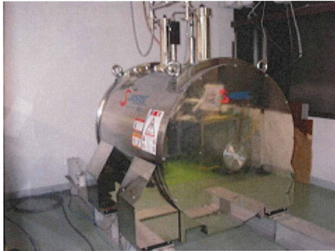
静磁場マグネット。静磁場強度 14.1 T、FRP製の48 mm径の水平ボアを採用。
