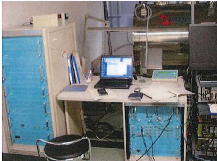
NMR スペクトロメータ (写真上の青い装置)。左側が RF パワーアンプ (1kW)、右側が送受信系。中央にパルサーの出力が並んでいる (24ch)。
