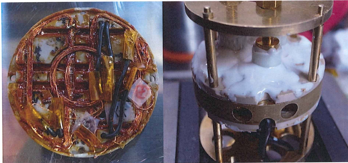
Fig.28 エポキシ接着剤による固定前（左）と固定後（右）
