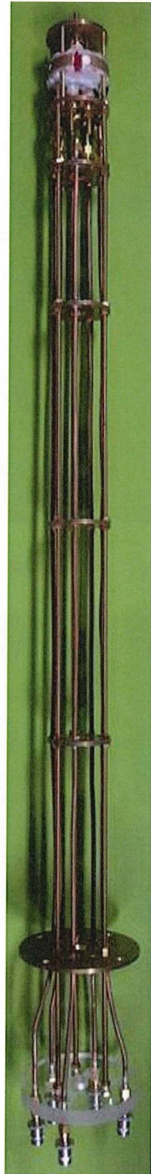
Fig.30 先行機の配線（左）はフレキシブルケーブル、右はセミリジッド同軸ケーブルに変更後
