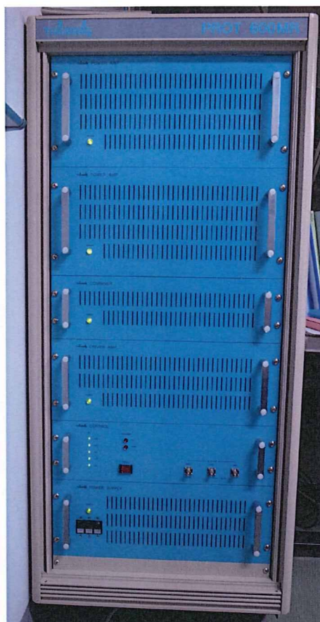
Fig.4 パワーアンプ
