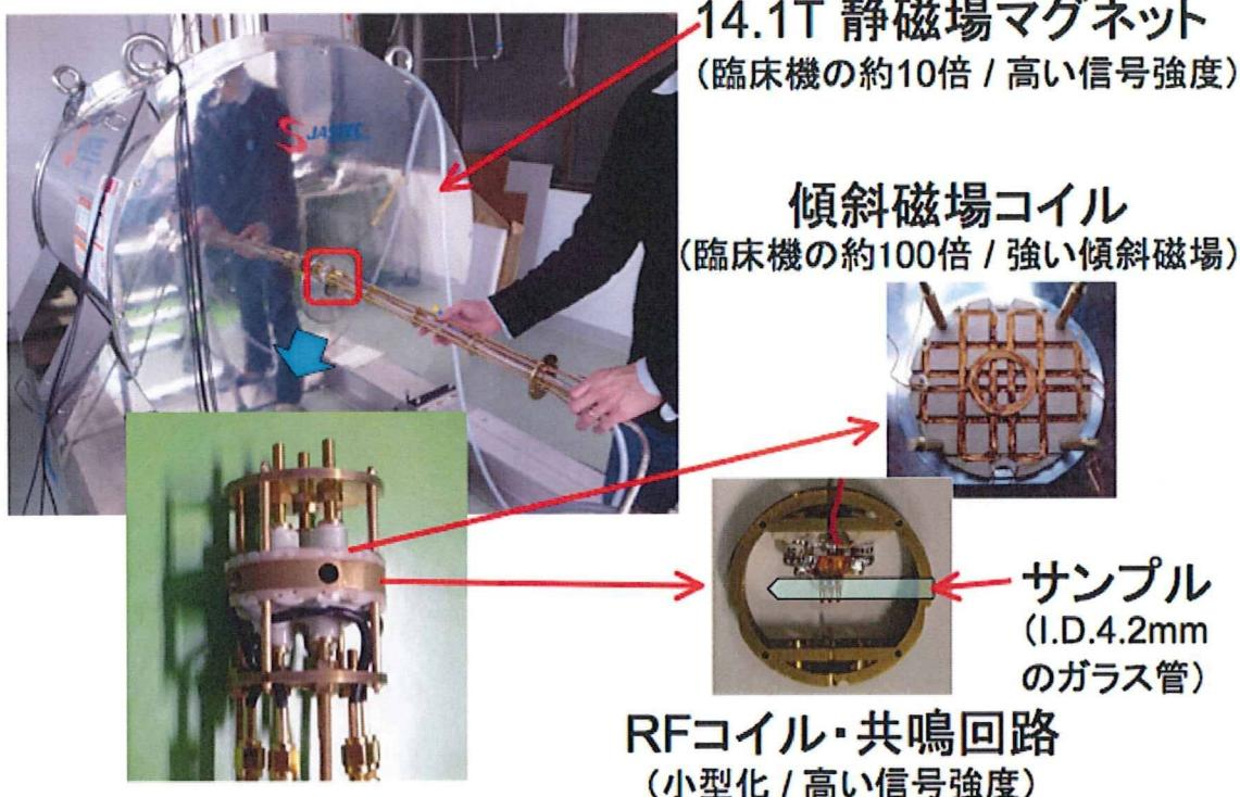
上図左上には、ボア径48mmの水平ボアを持つ14.1T静磁場マグネットが見える。これに開発したMRI顕微鏡プローブを挿入して、MRI顕微鏡による撮像を行なう。上図左下にMRI顕微鏡プローブのRFコイルと傾斜磁場コイルの組み合わさった先端部の拡大写真が示されている。RFコイル／共鳴回路の部分を平面型傾斜磁場コイルの2枚のプレートが挟み込むような形となっている。上図右中、右下に傾斜磁場コイル、RFコイル／共鳴回路の分解写真が示されている。傾斜磁場コイルは最終的にはPEEKのボビンに巻かれ（上図右中の写真は、コイルを片側のボビンに巻き終わった状態である）、非磁性エポキシ樹脂にて固定される。その後、G10の振動止と接着されて、上図左下のようにRFコイル／共鳴回路と組み合わされる。上図右下のRFコイル／共鳴回路は中央にサンプルを入れた外径5mmのNMRガラス管を挿入し、NMRガラス管中央にある試料の信号を観測する。
