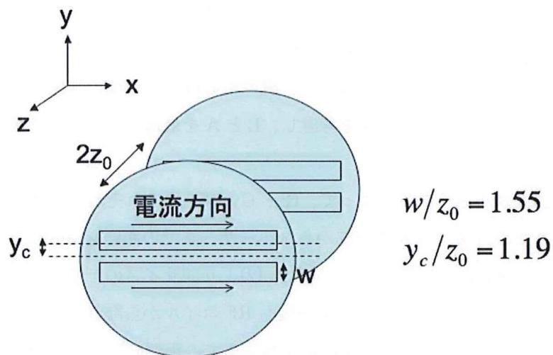
また、その時の傾斜磁場強度G<sub>x</sub>、G<sub>y</sub>は、真空の透磁率をμ<sub>0</sub>、電流強度をi、コイルの巻き数をNとした時以下のように表せる。
