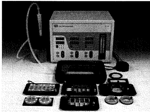
図3 顕微鏡用インキュベーションシステムとしてのChamlide TC システム (Live Cell Instrument: 以下 LCI とする)
