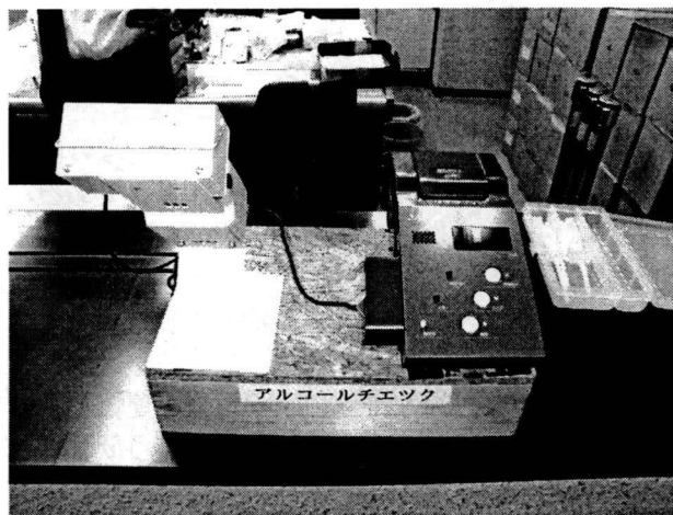
写真1 営業所入口に設置されたアルコール検査器
