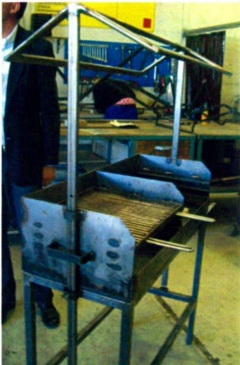
写真9 「溶接」で製作したバーベキュー台
