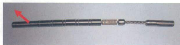
図2、線源容器内に格納されたイリジウムホルダー（長さ約17cm×径約0.7cm）。左端に径約2mm×厚約2mmのイリジウムが密封されている。
