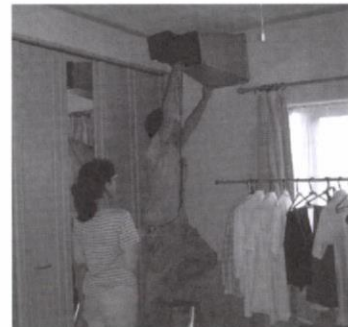
写真6 風量測定の様子
