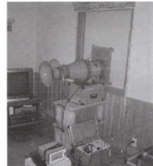
写真3 気密測定の様子
