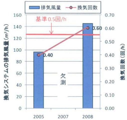
図4 換気システムの風量測定結果
