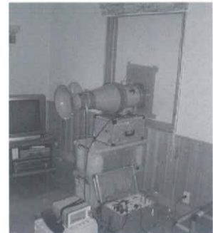
写真3 気密測定の様子
