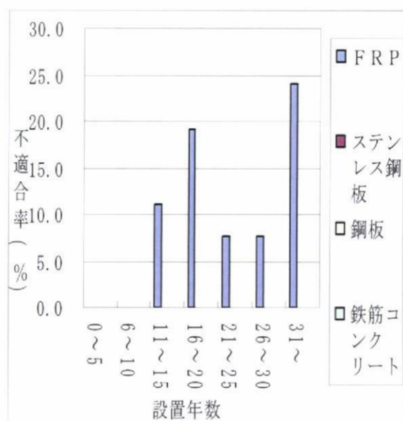
図 4-(1)-24 小規模貯水槽水道（高置水槽）
