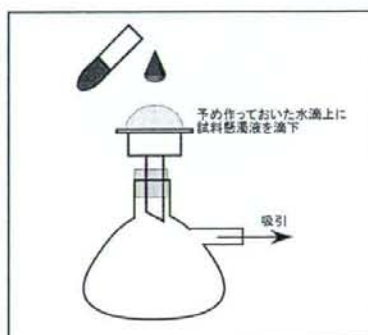
図2 懸濁液SEM試料調製法
