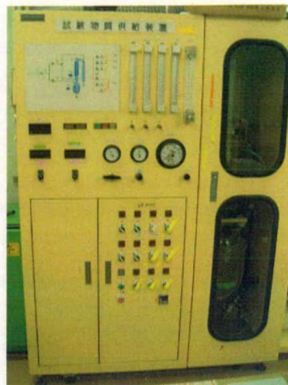
Photo. 1 3m 3 横層流大型チャンバー及びバブリング式発生装置 (柴田科学)
