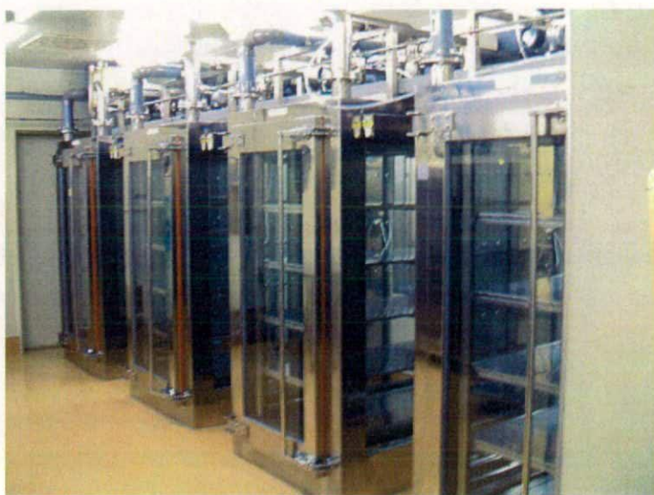
Photo. 1 3m 3 横層流大型チャンバー及びバブリング式発生装置 (柴田科学)
