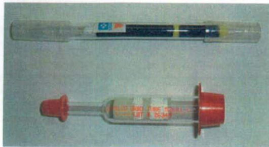
Photo. 3 活性炭捕集管(柴田科学) と DEHP捕集管(スペルコ, ORB0-5020)
