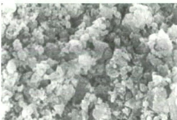
図1f 1MPaで成形した水酸化カルシウム圧粉体を72時間二酸化炭素暴露した試料断面のSEM像
