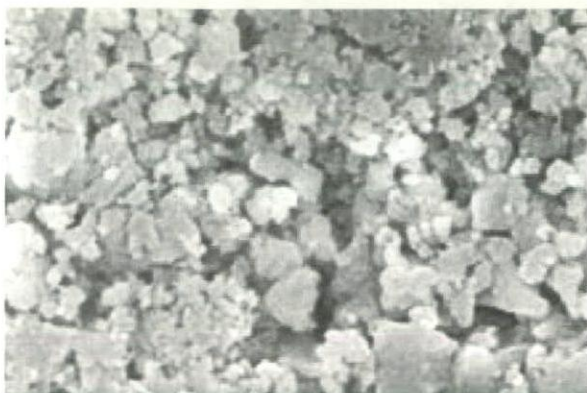
図1e 1MPaで成形した水酸化カルシウム圧粉体を72時間二酸化炭素暴露した試料表面のSEM像
