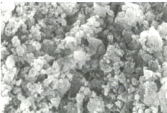
図2a 1MPaで成形した水酸化カルシウム圧粉体を72時間二酸化炭素暴露した試料断面のSEM像（図1dと同じ）
