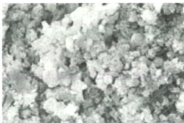
図2c 3MPaで成形した水酸化カルシウム圧粉体を72時間二酸化炭素暴露した試料断面のSEM像
