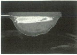
図1. 作製したハイドロキシアタパイトー コラーゲン複合体膜。水分を含むと軟性を示す。
