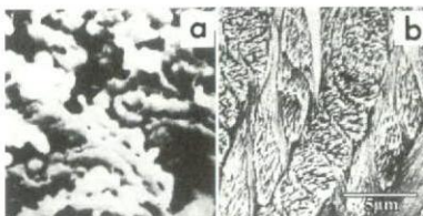
図46 アパタイトの2種の存在形態。a:合成アパタイト、b:天然骨(エナメル質)
