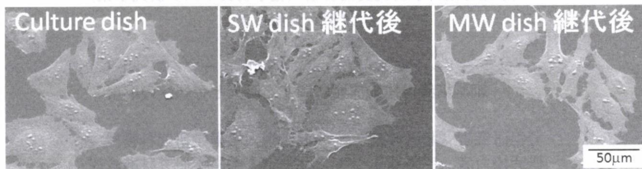
図7 各ディッシュ上で継代・培養した細胞を Culture dish に播種し直した後の SEM 観察象
