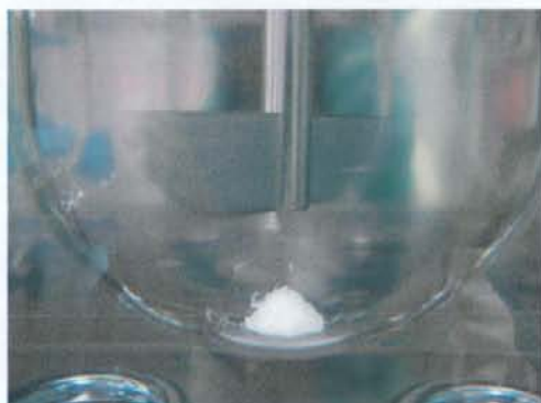
Fig.6 プレドニゾン標準錠のJPベッセルでの溶出挙動
