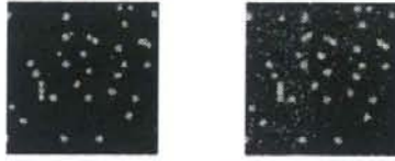
Fig. 1 濃度依存的バックグラウンド蛍光強度の増大。 様々な濃度に調製した F. tularensis ゲノムDNAを断片化後Alexa546で標識し、病原体検出用マイクロアレイ (MMDPA ver.1) とハイブリさせた。
