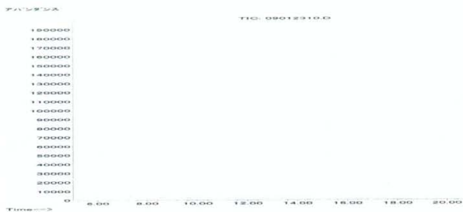
図-34 フロリジルカラムの溶出試験 (60 ~ 90ml 溶出画分) のクロマトグラム (各炭化水素を 2 \mu\text{g} 負荷し, 溶出液を 1ml に定容)
