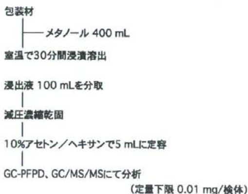
図1 包装材中のメタミドホス及びジクロルボスの分析方法
