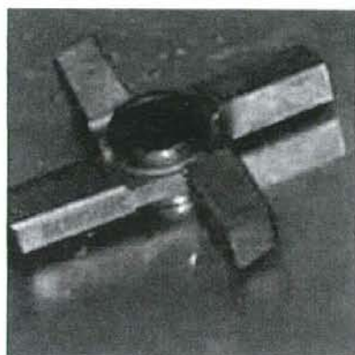
十字ナイフの刃部および付け根の溝部を拭取り
