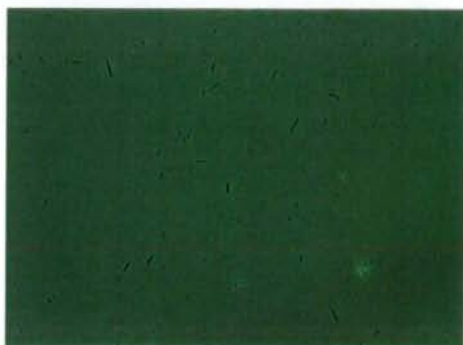
写真 10 アモサイト標準試料 (DLレンズ使用 総合倍率 400 倍)
