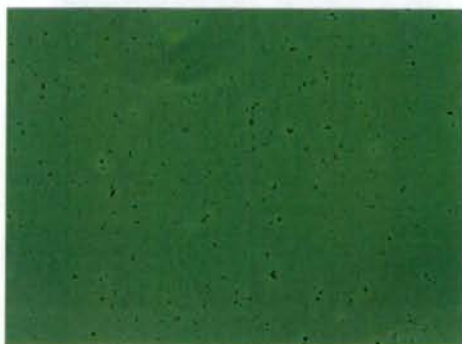
写真 12 クリソタイル含有建材試料 (浅野フレキシブル板) (DLレンズ使用 総合倍率 400 倍)
