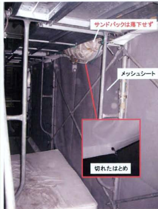
写真 15 実験③の実験後の状況
