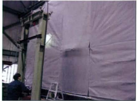
写真3 実験概要（水平荷重載荷時）
