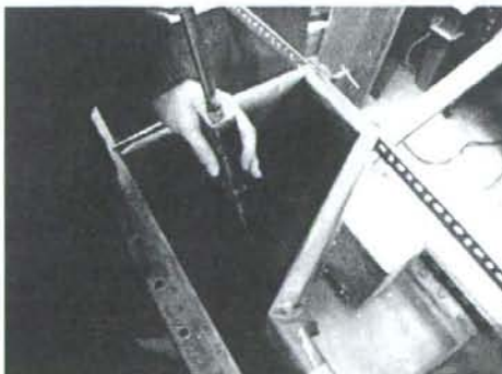
図-4.6 模型地盤の締め固め状況
