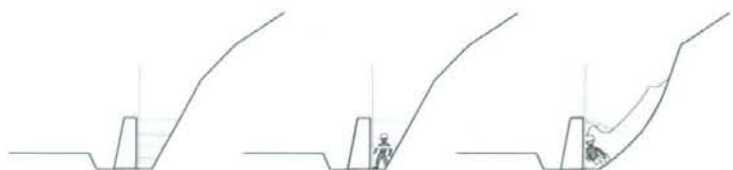
図-2.4 型枠の解体中の災害
