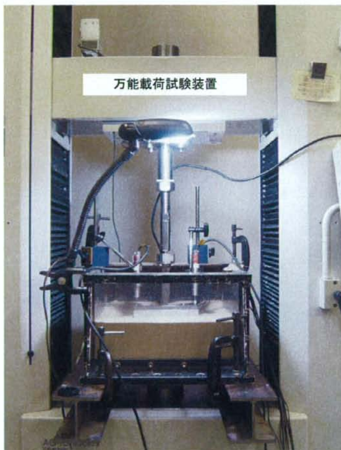
写真 6-3-2 精密万能試験装置 (Autograph)
