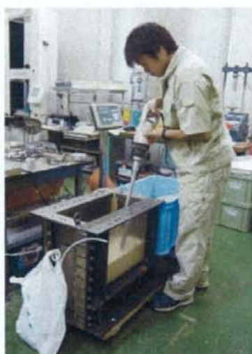
写真 6-1-4 模型地盤の作製
