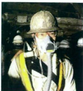
図 10 作業員への改良型 PDS-2 装着状況と呼吸用保護具内粉じん濃度測定状況
