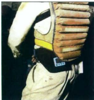
図 11 データーローガ部分の装着状況
