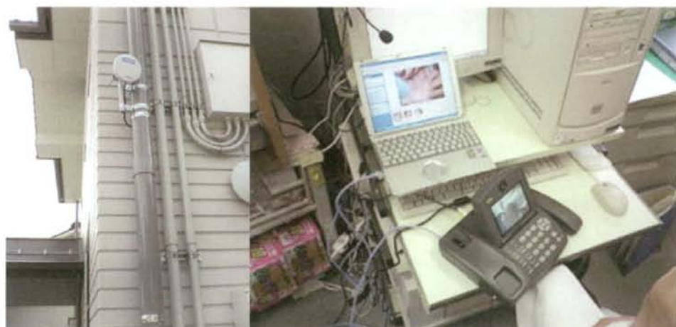
図 3 公共施設に取り付けた無線 LAN のアンテナおよび医師側のテレビ電話と PC
